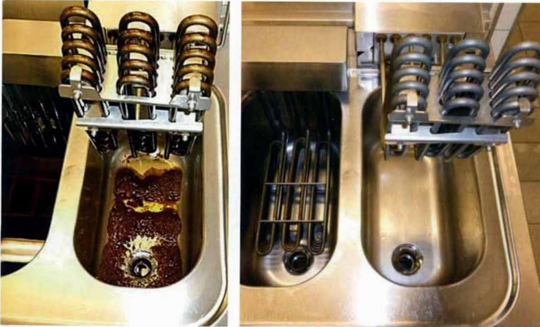
Die Inkrustierung von verbrannten Ölrösten bedeutet einen erheblichen Energiebedarf durch Leistungsverlust. Hier kann mit einem regelmäßigen Hygieneplan für Sauberkeit in der Fritteuse gesorgt werden.
