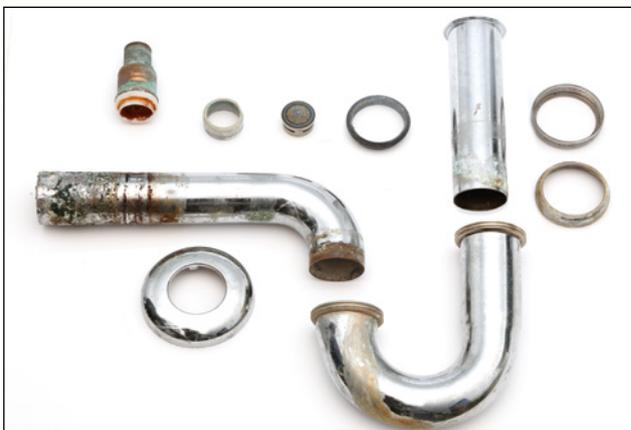
Komplett demontiertes Waschbeckenablauf-Siphon mit Kalk-, Grünspan- und Schmutzablagerungen.
