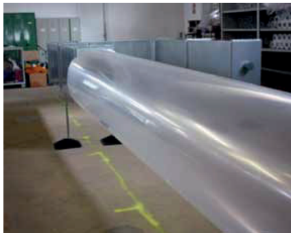
Der Versuchsaufbau im Bild: Die Luft wird über einen Schlauch in den Lüftungskanal geführt.
